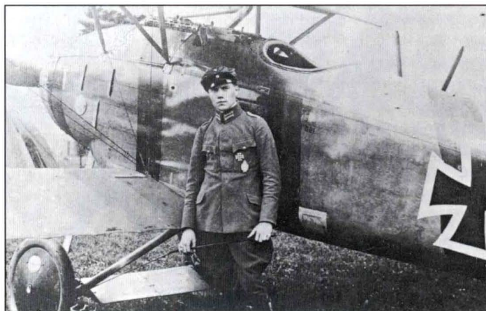
Kurt Wüsthoff pilotó este Albatros D III (OAW), marcado con una espiral negra, con la Jasta 4 en 1917. Muestra unos cubreruedas en gris oscuro o incluso en negro y, por lo demás, el camuflaje es el habitual. La banda negra en espiral alrededor del fuselaje era el distintivo de unidad de la Jasta 4 .
